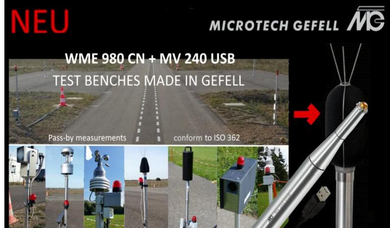
Zur Fernkalibrierung sind sie mit einem fernschaltbaren Kalibriergenerator ausgestattet, der über eine elektrostatische Vorsatzelektrode ein Kalibriersignal mit 1 kHz einspeist. Im Gerät befinden sich Schalter für einen Kabeltreiber und eine Mikrofonheizung, die einer möglichen Kondensation unter extremen klimatischen Bedingungen vorbeugt.
