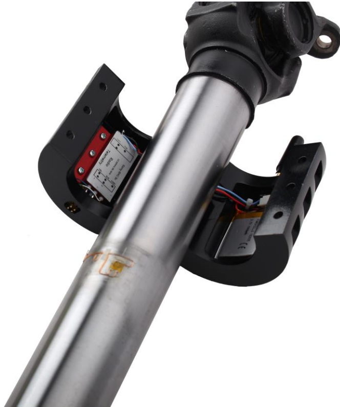
Abbildung 1: Seitenwelle mit Funktelemetrie aus 3D Druck
