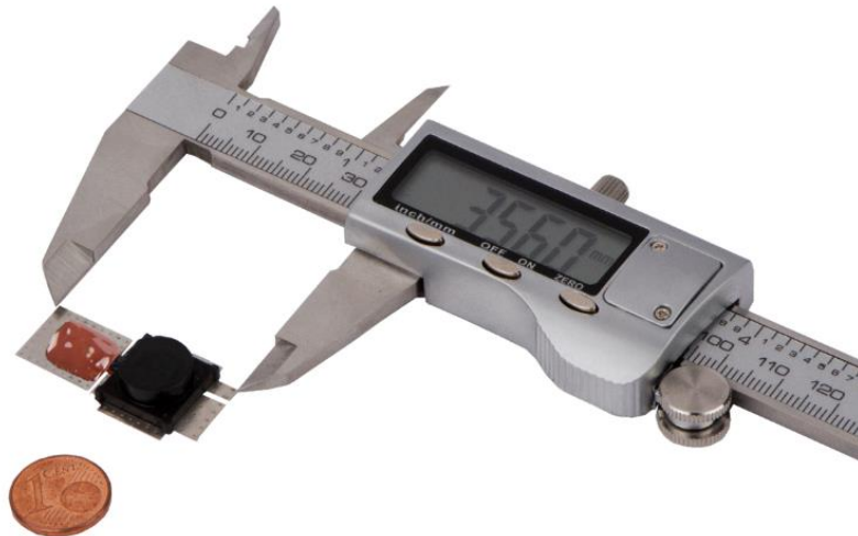
Torsionssensor mit integriertem telemetrischem Interface (35,53 mm x 18,1mm x 6,25 mm)
