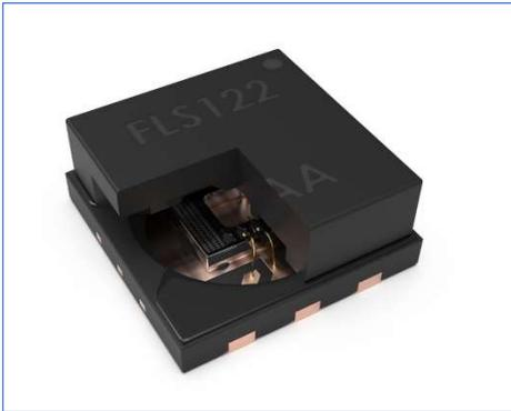
3 – Flussos neuer Luftgeschwindigkeitssensor FLS122 verwendet ein CMOS-MEMS-Die, das auf dem preisgekrönten Durchflusssensor FLS110 basiert. Das obige Schnittbild zeigt die Sensormembran, drei der fünf Heiz- und Sensordrähte sowie die mit dem Leiterrahmen verbundenen Goldbonddrähte innerhalb des Gehäuses.
