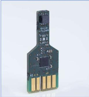
2 – Zu Flussos FLS122-Evaluationskit gehört ein erweitertes Sensormodul (hier abgebildet), das direkt in einen Strömungsweg eingesetzt werden kann.
