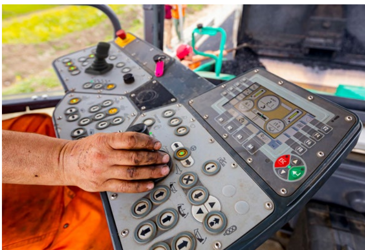
Bild 1: Die Minijosticks von Althen sind intuitiv zu bedienen und erlauben eine präzise Steuerung in bis zu drei Achsen. Oberhalb der Paneloberfläche entsprechen sie der Schutzart IP 67 und sind deshalb auch für raue Umgebungen geeignet. Bild: Bigstockphoto.com / Althen.de
